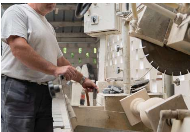
Octobre - novembre : dépose et restauration de la balustrade en atelier.
