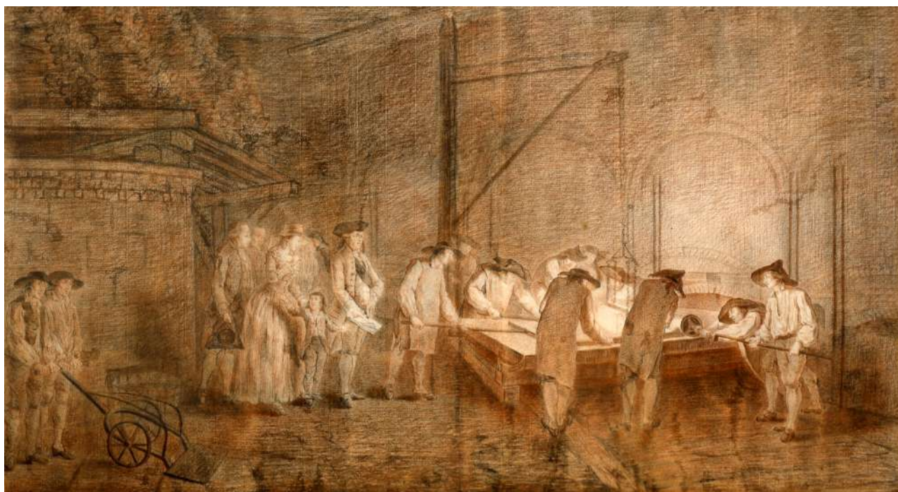
Coulée d'une glace à Saint-Gobain (Picardie) en présence du directeur Pierre Delaunay-Deslandes, vers 1770-1780. © Archives de Saint-Gobain.
