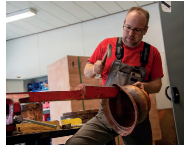
Création de la gerbe centrale du bassin en atelier © château de Versailles, D. Saulnier
