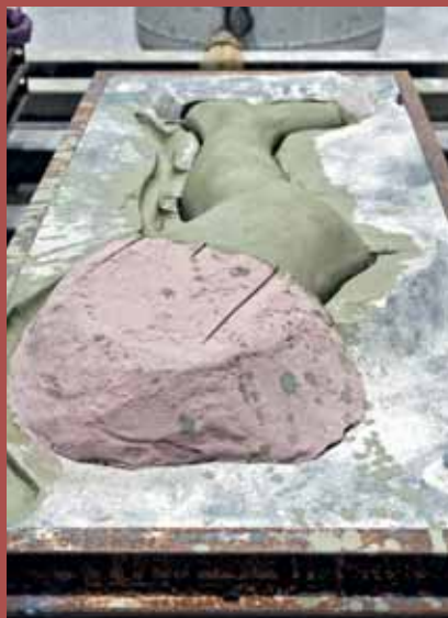
Confection du moule pour la coulée de plomb © château de Versailles, S. Giles
