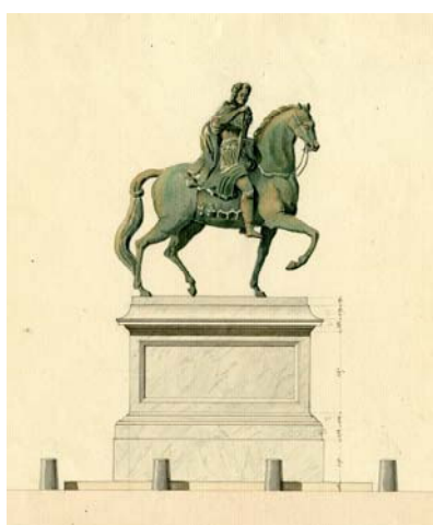
Elévations, plan et coupe du modèle à l'échelle grandeur du piédestal de la statue équestre de Louis XIV Détail du dessin coté avec la mention « Fait dans les bureaux de Monsieur Nepveu, Architecte du Roi en 1836 par C. Le jeune » Service des Archives et plan de l'Établissement public de Versailles © Cabinet Didier
