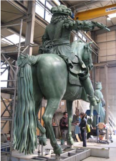
Statue équestre aux ateliers de la fonderie Coubertin, réalisation de la patine finale, mars 2009 © Cabinet Didier
